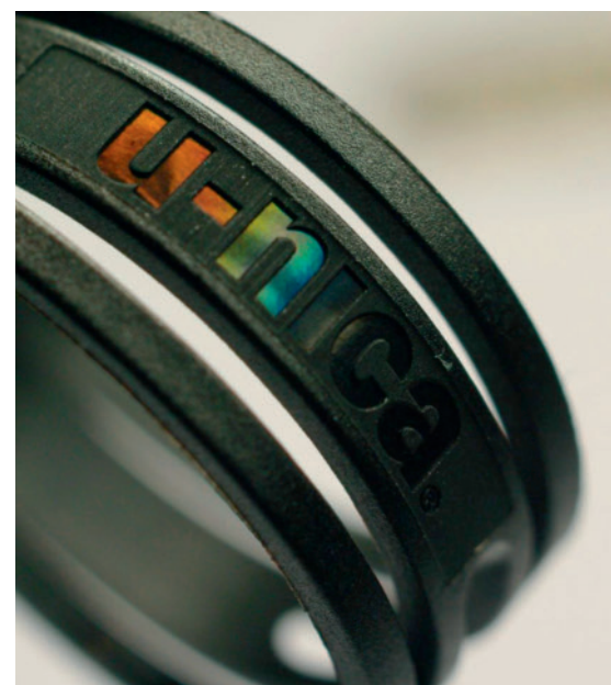
Bild 2. Optische Diffraktionsstruktur in einer Kunststoffoberfläche als Sicherheitsmerkmal
