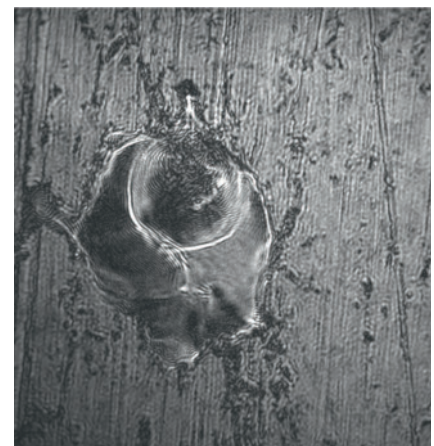
Bild 4. Mikroskopisches Sicherheitsmerkmal für elektrisch leitende Metallkörper. Nachweis mit 3D-Rasterkraftmikroskopie (Bilder: Phasis)
