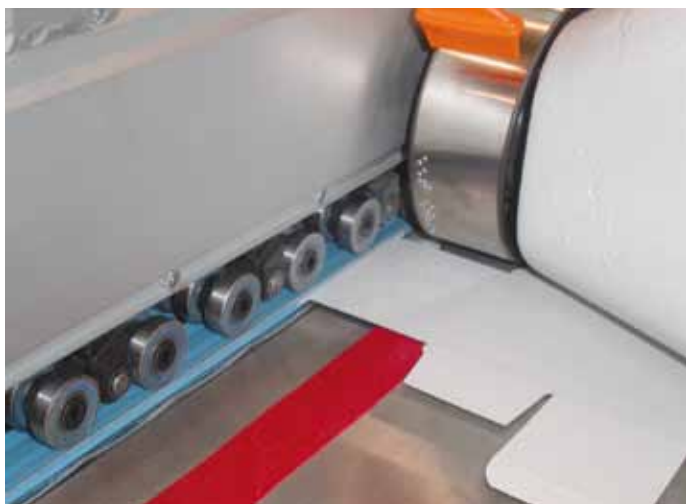
Die Produktion von Pharmafaltschachteln mit in der Klebmaschine hochgeprägter Blindenschrift ist längst Standard in der Branche. Bei K+D AG heisst dieser Bereich «K+D Accubraille», dessen Vorzüge in der perfekten Lesbarkeit, der höchsten Braillequalität und einer kürzeren Produktionszeit begründet sind.
